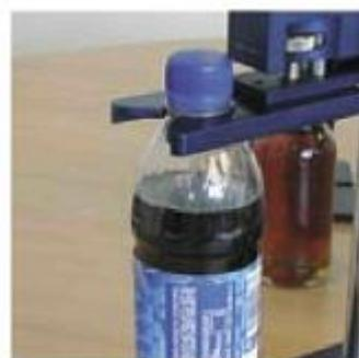
**Блок прокалывания металлических крышек и банок 32114.** Имеет прокалывающий нож 32106А и позиционирующее устройство 32108.
