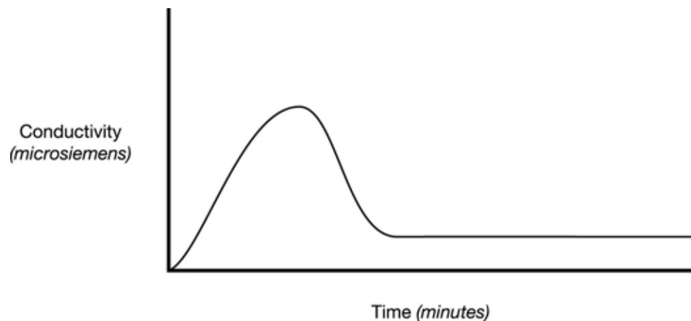
Fig 5-15 : P3-Type Oxidation Curve
