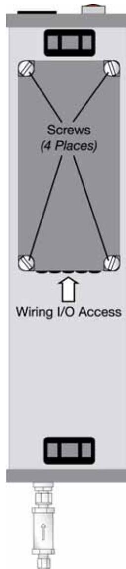
Fig 2-21 : TOC600 Analyzer: Bottom View
